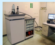
SQUID 磁化測定装置 (MPMS)
