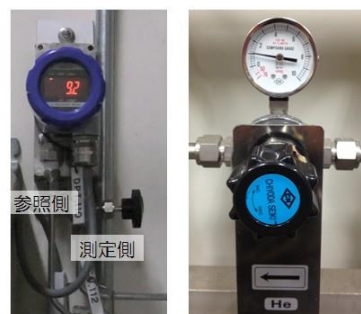
図 2：従来用いていた調整器圧力計(右), と新たな気密試験で利用した差圧計(左)
