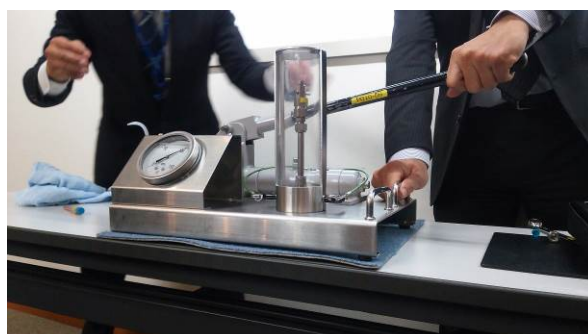
図 2 チューブ継手の水圧試験
