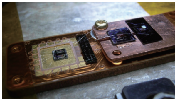
図 2 2つの検出素子と 2ch dc-SQUID 信号増幅器を組み込んだ信号検出システム
