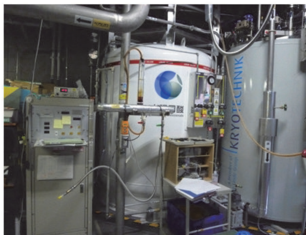
図 1 (右)ヘリウム液化機 Linde 社製 L140、 (中央)Wegissington 社製貯槽（容量 2,500L）、 (中央手前)小分け汲出用オイルバブラー。
