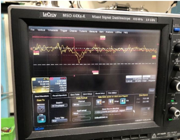
図 3. TES の光子入射時の信号波形
