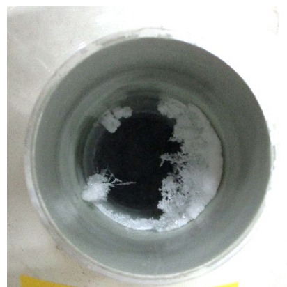
図6 開放型容器 ネック部 内壁の水
