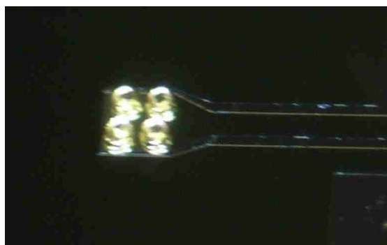
図 2 超伝導イリジウム/金薄膜上に 4 個の金バンプポストを形成した温度センサ部
