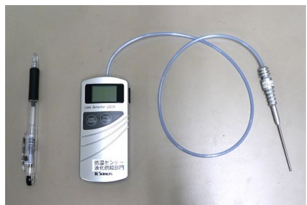
図2. 低温センターで貸し出しているハンディタイプのリークディテクタ
