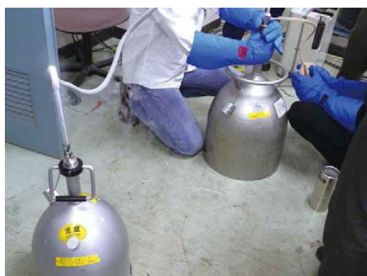
図 1: サイフォンによる液体窒素の移送
