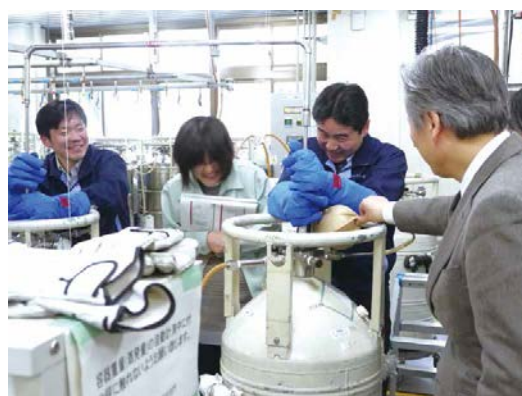
図 2: 液体ヘリウムのトランスファー
