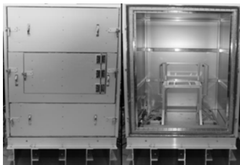
図 3 実験室の小型磁気シールドボックス
