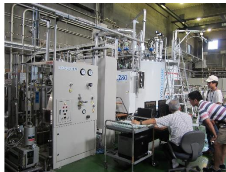
図 2. 筑波大学の乾燥器(左)、液化機(中央)、貯槽(奥)
