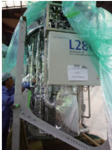
図1 ヘリウム液化機 L280 (左：内部、右：カバー)
