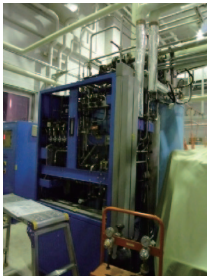
図2 ヘリウム液化機 TCF50 (左：全体図、右：コールドボックス外部の熱交換器 拡大図)
