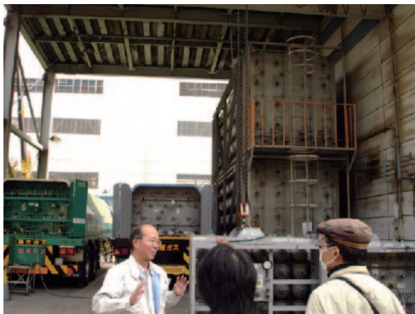
図3 長尺ポンベ(右奥、20本×2段) (奥中・奥左はローダー、手前はミニカードル)
