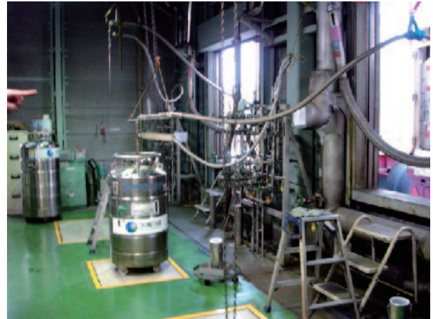
図2 充填用2重管と60L容器
