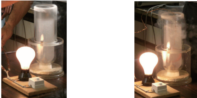
図 8. 電球の明るさの変化（左：冷却前、右：冷却後）
