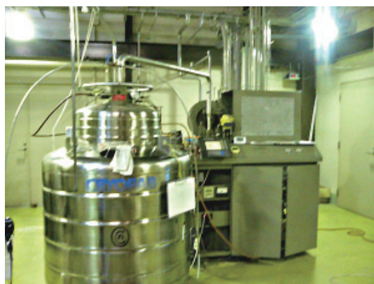
図1. ヘリウム液化機 PSI 社 M1610
