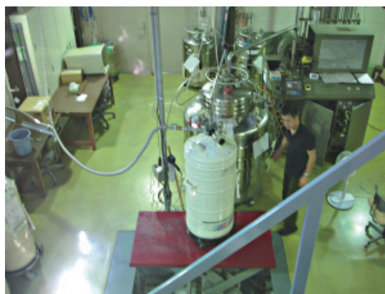
図3. 液体ヘリウム汲み出しの様子
