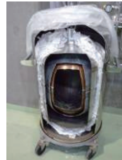
図6. LN2 シールドの LHe 容器カットモデル
