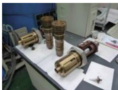
図2 タービン (右: 故障したタービン)
