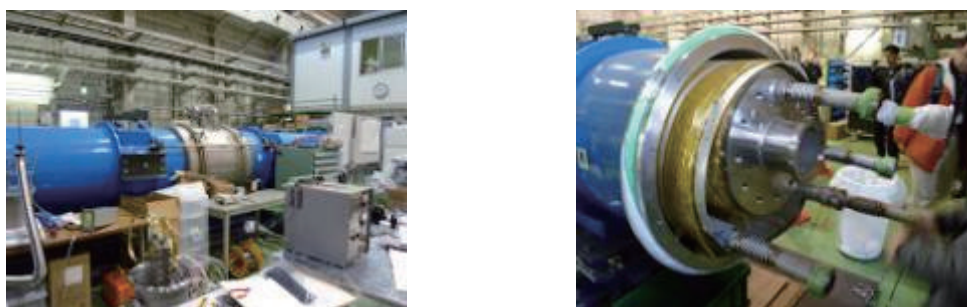
図9. 超電導磁石(左:全体図、右:内部)
