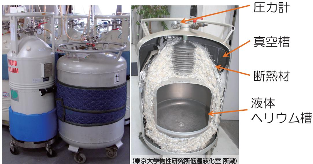
図 20 液体ヘリウム容器 (左)外観、(Cryo Diffusion 社 NMH100、Messer 社 Helios) (右)構造 (Messer 社 Helios)
