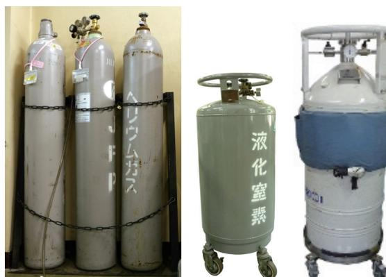
図 2 本学で使用される高圧ガス容器の例
