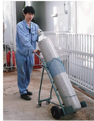
図 27 容器運搬車の使用例[8]
