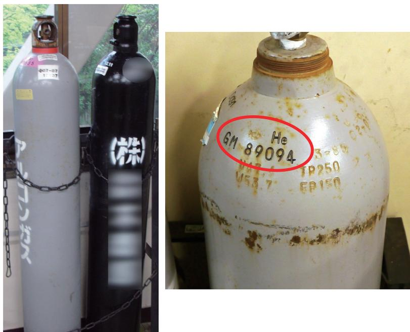
図24 (左)ガスボンベの外観、(右)刻印の例(ガスの種類と記号番号)
