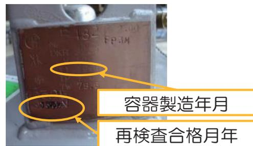
図 18 検査刻印の例
