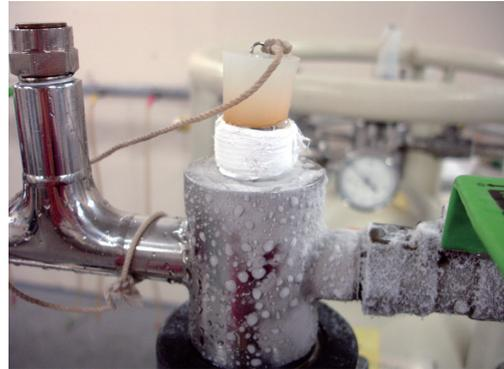
図 22 液取り口に隙間がある例
