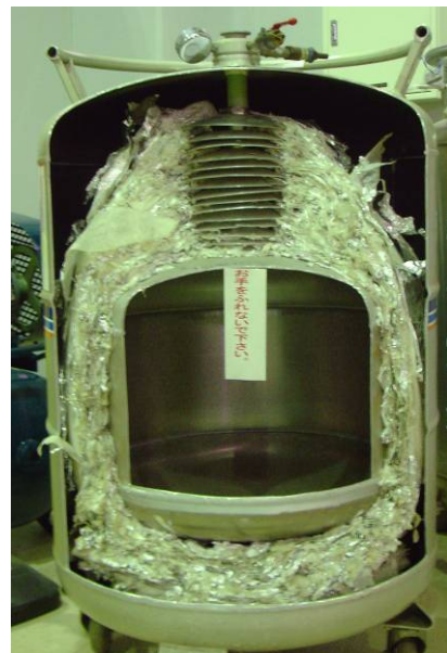
図10：ヘリウム容器の構造(左)、実物のカットモデル(右)
