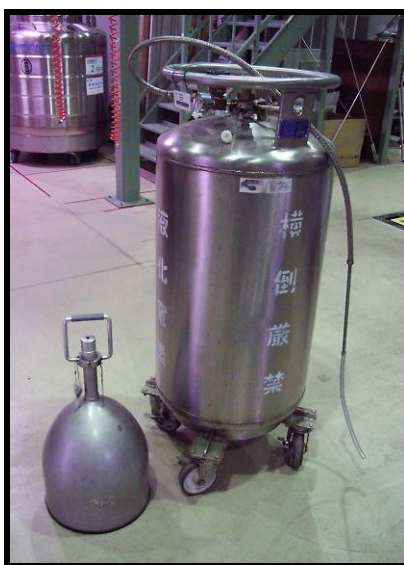
図6：開放型容器(左)と自加圧式容器(右)
