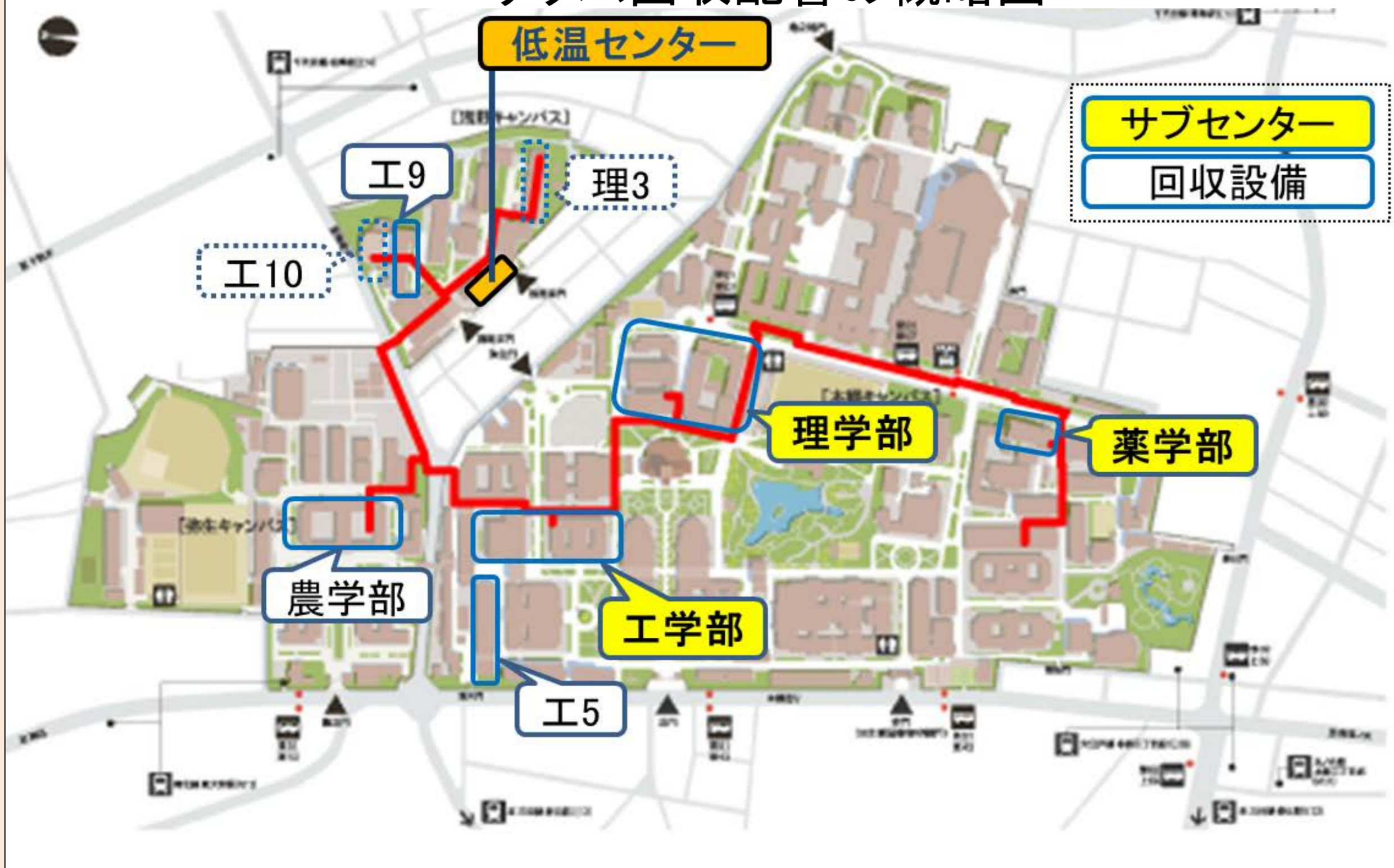
本郷地区キャンパス地下共同構内 ヘリウム回収配管の概略図
