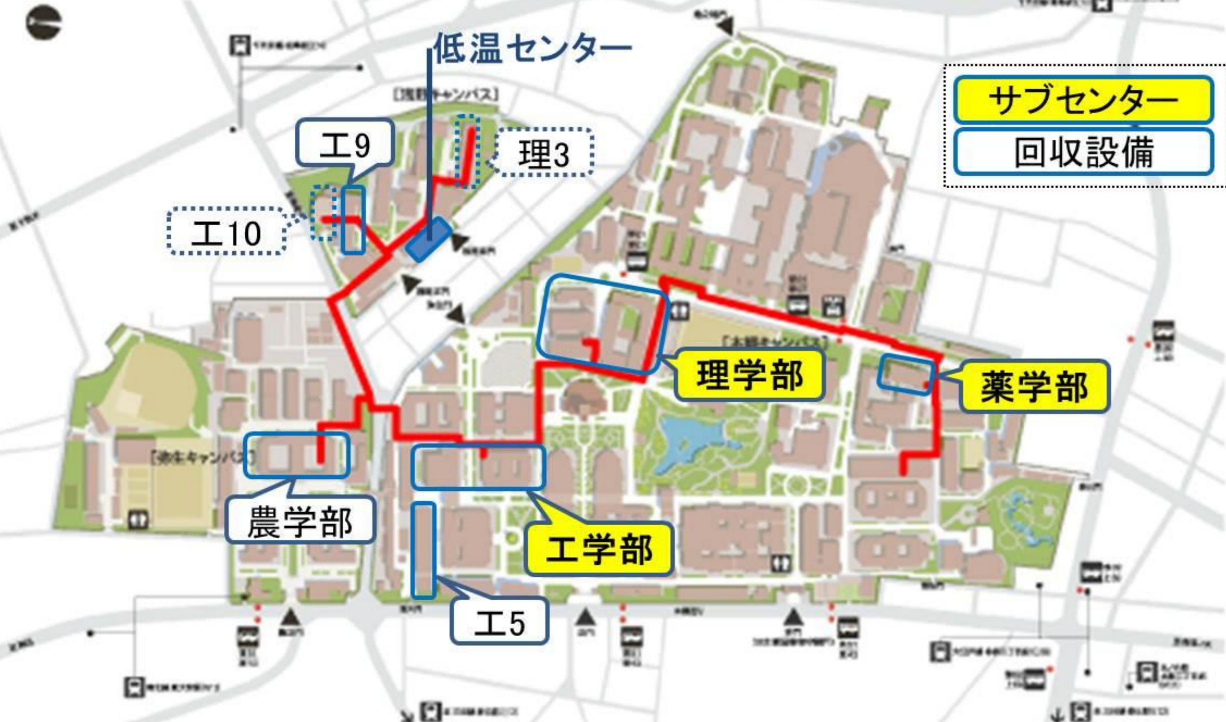
本郷地区キャンパス地下共同構内 ヘリウム回収配管の概略図
