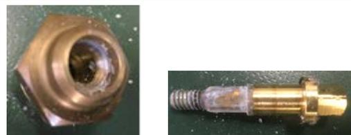
パッキンの摩耗により、内部に細かいテフロンのはがれカスが溜まっている（ガス漏れの原因）
