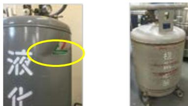
図1 外観検査（左）容器の凹み、（右）腐食
