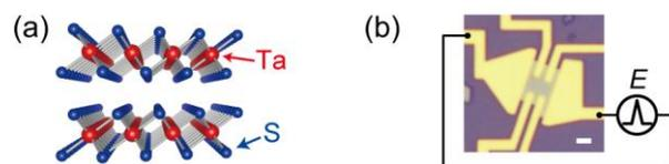
図 1. 二次元結晶デバイス. (a)  $1\text{T-TaS}_2$  の結晶構造. (b)  $1\text{T-TaS}_2$  超薄膜デバイス. スケールバーは  $1\ \mu\text{m}$  を表す.
